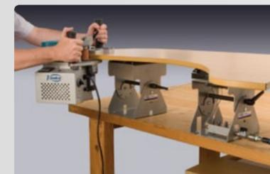
Sujeción de una pieza de grandes dimensiones con una unidad auxiliar SVN470 conectada al distribuidor del SVN450.
