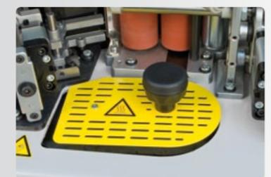
Depósito de cola con recubrimiento de Teflón® anti-adherente. Cantidad de cola a depositar sobre el canto regulable.
