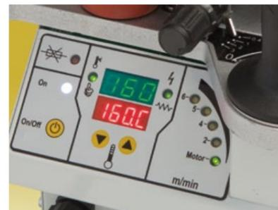
Regulación de la temperatura (120 a 200°C) controlada por microprocesador para una mayor exactitud en la medición. Sistema de elevación de la temperatura por impulsos. Protege las resistencias y aumenta su durabilidad.
