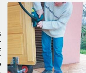
Es posible bloquear las ruedas para una utilización estacionaria; lo que permite realizar cualquier intervención en el canto del panel o puerta.
