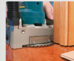
Recorta marcos, sin desmontar los tapajuntas, asegurando un corte impecable y preciso.
