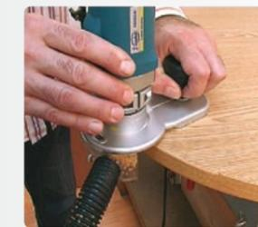
El cabezal opcional CA56U permite el perfilado ininterrumpido de los cuatro cantos de un panel. Con una gran base de apoyo y pomo auxiliar para la sujeción. Ideal para la realización de trabajos de enrasado en el borde del panel.
