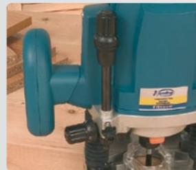
Sistema de ajuste fino (décimas de mm) y milimétrico más preciso y estable de la profundidad de fresado. 6 toques de profundidad de ajuste rápido.
