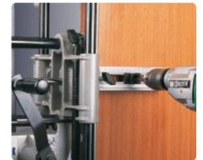
(Incluido en el equipo) usando el útil UT16I se obtiene la referencia para taladrar el alojamiento del bombín y aguja.
