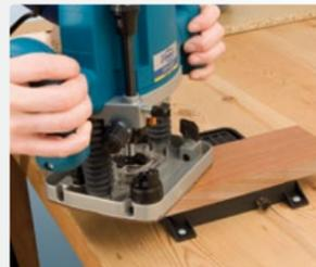
Sujeción de piezas pequeñas sobre una porción dividida del plato de sujeción. Fija en horizontal y en vertical.
