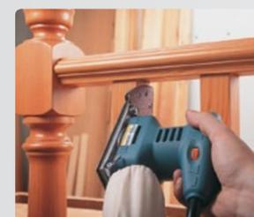
Utilizando la base con punta de delta, el lijado de difícil acceso resulta fácil y cómodo.
