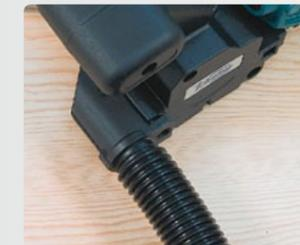
Equipado con toma para la conexión a un aspirador
