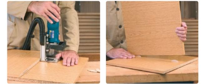
Ensamblaje en medio del tablero
