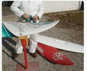
Lijados en piezas compuestas de capas de diferentes materiales con distinta dureza y textura.
