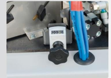
Regulación simultánea con sólo un contador digital, para el espesor del canto y las posiciones de la guía de entrada y del rodillo aplicador de cola.
