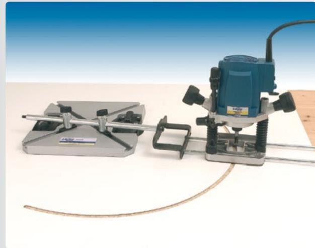
Elipses, longitud máxima eje mayor: 3200 mm, longitud mínima eje menor: 600 mm (con fresadoras tupí).
