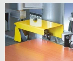
Retestado del canto sobrante anterior y posterior (en cantos de hasta 2 milímetros de espesor).
