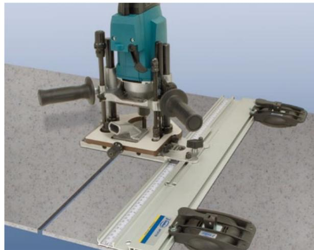
**1745838 Equipo para cortes paralelos y fijación UF317S (Incluye ventosas)**
