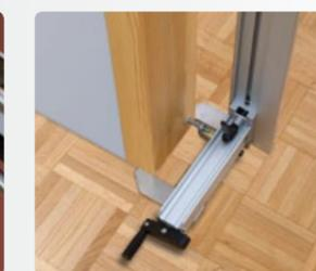
Práctico sistema de fijación al marco mediante mordazas. Regulación del corte simple y rápida. Incorpora plomada para facilitar el corte vertical.
