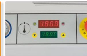
Selector digital de la temperatura de trabajo. Control automático de la temperatura. Cambio automático a T de espera de 110° C tras 30 minutos sin aplacar, para evitar degradar en exceso la cola.
