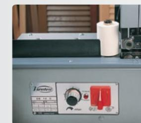
Regulación electrónica de la temperatura.
