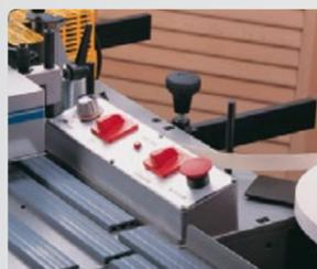
Regulación electrónica de la temperatura.
