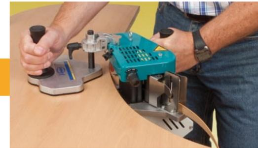
Guía de apoyo inclinable hasta 10° para facilitar encolados en puertas.
