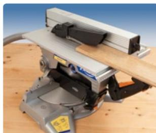
Nueva mesa superior, más amplia, para trabajos auxiliares. El corte es regulable de 0 a 55 mm y dispone de un regle con escala milimetrada para facilitar el corte. Permite adaptar una escuadra (opcional) para cortes guiados en ángulo. (ver accesorios opcionales pág. 68)
