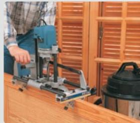
Posibilidad de trabajar en posición horizontal. Muy útil si se desea realizar en serie los cajeados, con las puertas descolgadas.
