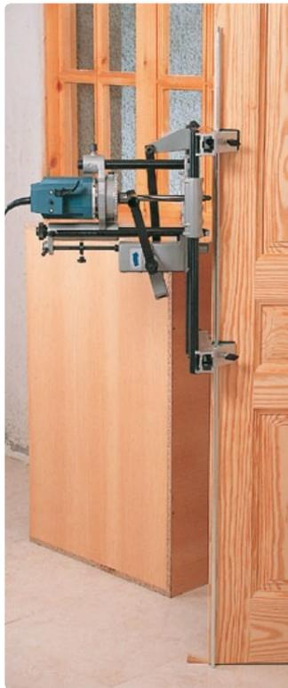
La FC116U incorpora una varilla de tope, que se fija a la máquina, a la altura del suelo establecida para la primera puerta cajeadada, permitiendo cajear las demás puertas, a la misma altura, sin tomar medidas de nuevo.
