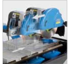
El innovador sistema telescópico permite grandes longitudes de corte (hasta 730 mm)
