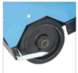
Alineación precisa de la máquina mediante indicador de corte
