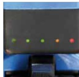
Indicador de sobre carga de motor, por LED
