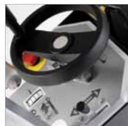
Ajuste de profundidad de corte y regulador de velocidad muy cómodos para el usuario
