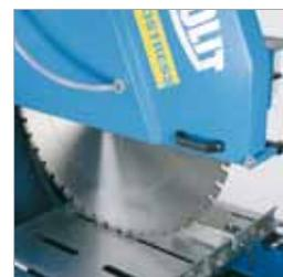
Posibilidad de grandes profundidades de corte de hasta 380 mm (con disco de corte Ø 1000 mm)
