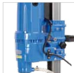
1 marcha para diámetro de perforación de hasta 160 mm
