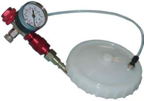
Regulador de caudal de aire con manómetro para depósito de gravedad. Con nuevo sistema de montaje y desmontaje rápido, sin necesidad de herramientas. Especialmente indicado para masillas, productos densos y acabados en hebras. Presión máxima de trabajo del depósito 3 bar. Compatible con todas las pistolas de gravedad "KRIPXE" (excepto E-21 y F-22).
