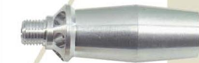
Boquilla multiplicadora de aire, su diseño le permite aspirar el aire ambiental y gracias al "efecto venturi" incrementa el caudal de aire expulsado.
