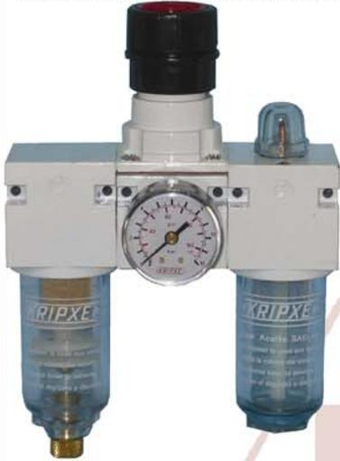
Regulador + filtro + lubricador para instalaciones neumáticas. Regula la presión de aire y la cantidad de aceite con la que se quiere que trabaje, además elimina las impurezas y la humedad del aire comprimido.
