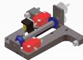
DOBLE FINAL DE CARRERA ELECTRICO PARA REGULAR EN ALTURA, ALZADA Y DESCENSO DE LA CARGA.
